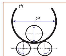
Creusabro® 8000® kan varmformas vid temperaturer på 500 - 550°C, utan krav på ytterligare värmebehandling. Vid denna temperatur kräver formningen lägre kraft (på grund av reduktion av sträckgränsen) än vid rumstemperatur.
