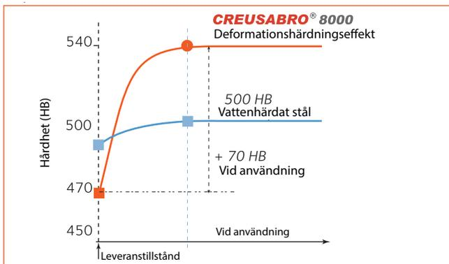
Dessutom så ger superduktiliteten hos restausteniten även en förbättrad livslängd genom större mikroskjuvning, som resulterar i att avverkning av bitar (tearing) fördröjs från ytan som utsätts för förslitning.
