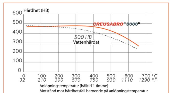
Det är också möjligt att bearbeta stålet vid hög temperatur, 500–550°C (varmformning, böjning, valsning) följt av en långsam avsvälning i luft, utan få ett signifikant hårdhetsfall (ungefär 30–50HB).
