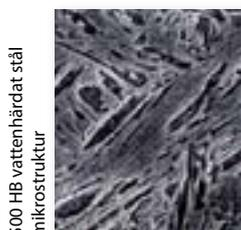
500 HB vattenhärdat stål mikrostruktur
